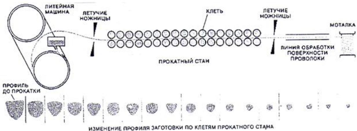
Рисунок 1.7 – Литейно-прокатный агрегат с роторным кристаллизатором
