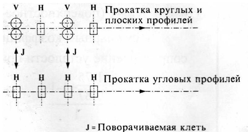
Рисунок 2.12 – Использование поворачиваемых клетей (горизонтальных и вертикальных) на сортовых станах для прокатки простых профилей небольших размеров
